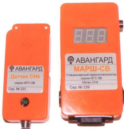
Цифровая трёхразрядная матрица показывает концентрацию по измеряемым газам: CH<sub>4</sub> в % ГС имеет возможность выдавать сигналы так же в аналоговом виде (0 - 3 В; 4 - 20 мА)
